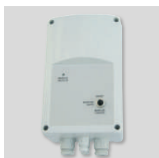
VAPZ Reguladores electrónicos de tensión para ventiladores monofásicos 230V-50Hz. Controlan la velocidad del ventilador mediante contacto simple (detector de presencia) o una entrada analógica 0-10V o 4-20 mA (de CO 2 o transmisor de presión).
